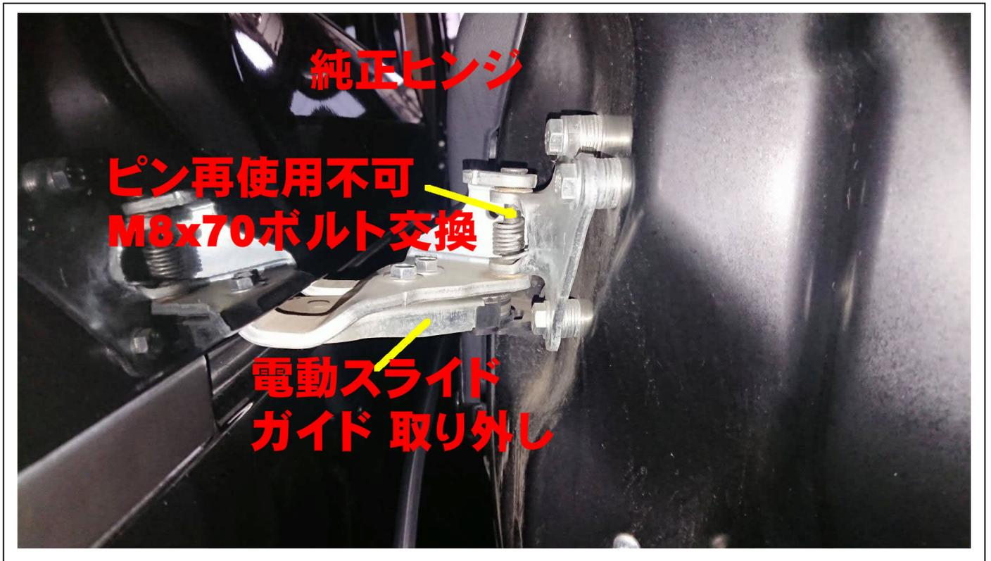
\* ヒンジスライドレール側は 再使用 ピンは再使用不可 M8x70 ボルトナットセットに交換
