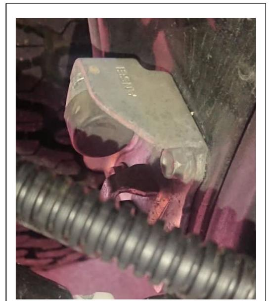
\*スライドドア 開閉 動作確認を行う スムーズに開閉しない場合は M8 ボルトナットを 若干緩め 角度の微調整を行う
